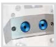
Interfaccia esterna: trasmissione di tutti i dati dei sensori in valore analogico | lettura e trasmissione dei valori tramite Bluetooth®
